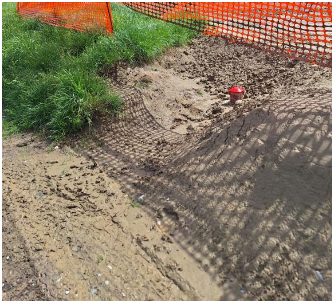
Figura 3: Piezometro di monitoraggio
